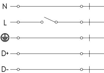
**IT** - Carico elettrico massimo 1200W - 50V-1A FELV Sezione cavi: 5 x 12AWG "NEC/CEC according"
