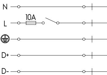
**IT** - Carico elettrico massimo 2500W (10 A e 250V). Sezione cavi: minima 1.5mm<sup>2</sup> e massima 2.5mm<sup>2</sup>. 50V-1A FELV
